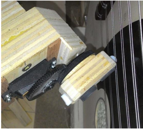
Resim 2.5. Bilgisayar kontrollü mızrap vuruş sistemi
