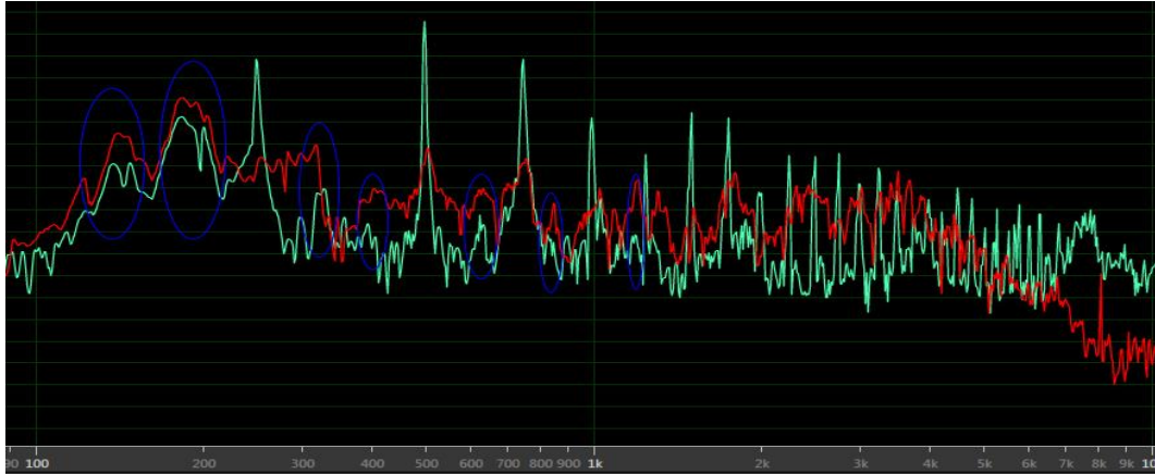
Şekil 3.2 tabla ve telden elde edilen seslerin spektrum analizi
